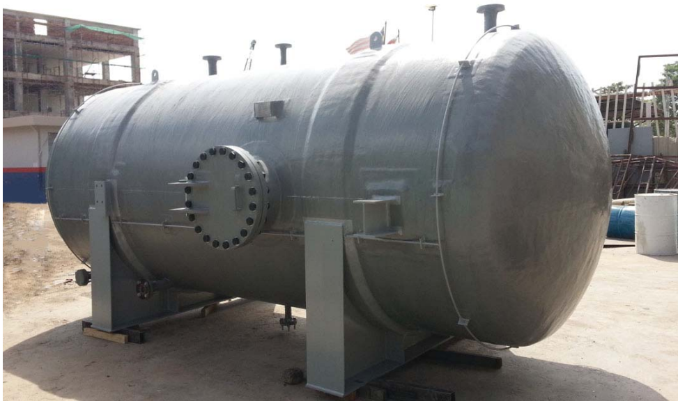
รูปที่ 3-5 ภาพตัวอย่าง ถังเก็บกรดเกลือ ชนิดวางนอน (Horizontal tank) วัสดุ ไฟเบอร์กลาส
