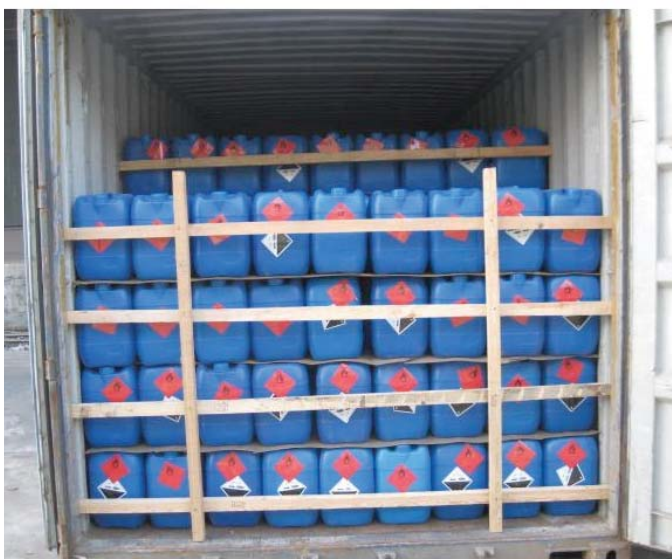
รูปที่ 4-1 ตัวอย่างวิธีป้องกันการเคลื่อนตัวของบรรจุก้อนสารเคมีเพื่อการขนส่ง
