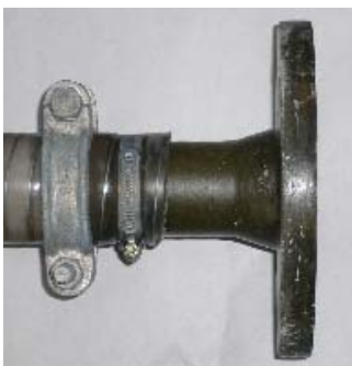
รูปที่ 3-6 ปลายข้อต่อ เป็นชนิดหน้าแปลน ขนาด 3 นิ้ว JIS 10k
