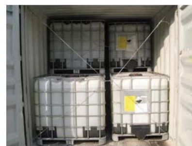
รูปที่ 4-1 ตัวอย่างวิธีป้องกันการเคลื่อนตัวของบรรจุก้อนสารเคมีเพื่อการขนส่ง
